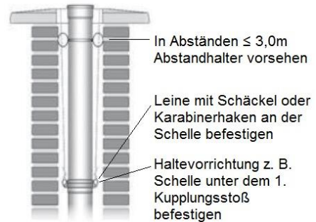
Abb. 11, Rohrelemente im Schacht ablassen
