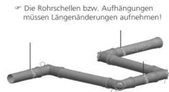
Abb. 4 Typische horizontale Dehnungsaufnahme
