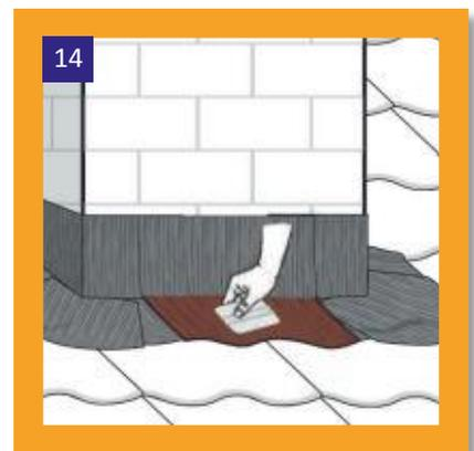
Die Anschlussbänder werden mind. 5cm überlappend an den Schornsteinabdeckungs-manschetten und dem Bauteil befestigt.
