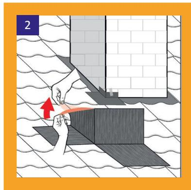
Entfernen Sie die Schutzfolie des oberliegenden Klebekragens auf der linken Seite.
