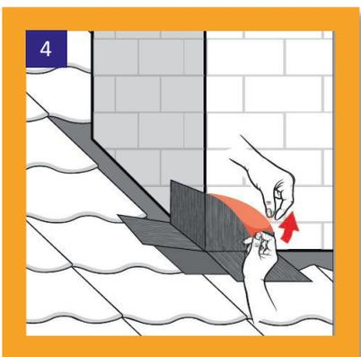
Entfernen Sie die Schutzfolie des oberliegenden Klebekragens auf der rechten Seite und drücken Sie den Klebekragen ebenfalls an das Bauteil.
