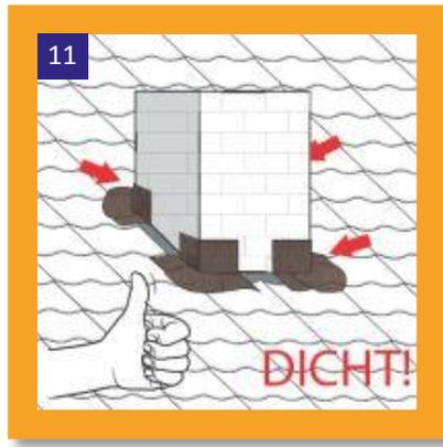
Kleben Sie das Anschlussband auf die Dachpfannenfläche zwischen den Eckenabdichtungen. Drücken Sie mit dem Daumen das Anschlussband sorgfältig an die Dachpfanne.
