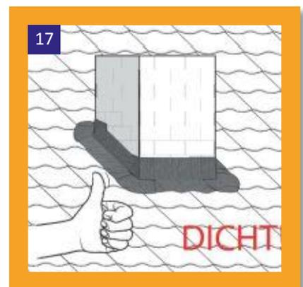
Das Anschlussband muss an allen vier Seiten nach dem gleichen Prinzip verbaut werden. Bitte achten Sie speziell bei Dachschrägen auf die erforderliche Überlappung von mindestens 5cm.
