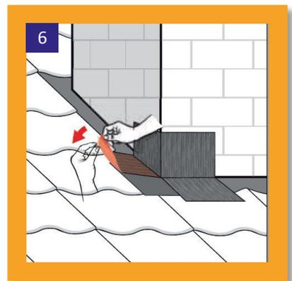
Entfernen Sie die Schutzfolie auf der linken Seite und kleben Sie die Fläche gerade auf die saubere und fettfreie Oberfläche.
