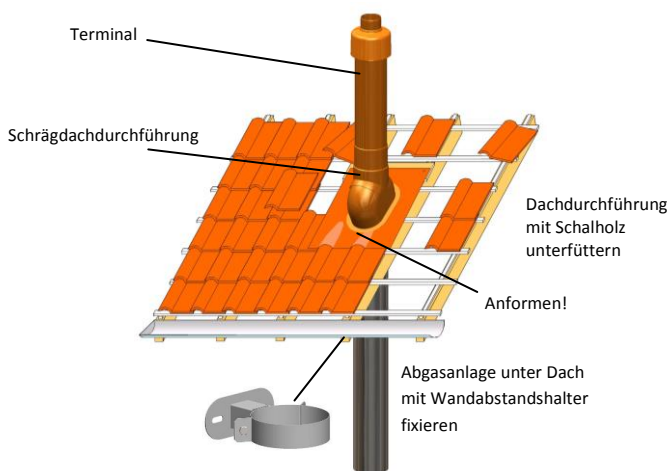
Abb. 8 Schrägdach mit typischer Dachhochführung
