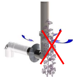
Abb. 5 Verbrennungsluft-Ansaugung frei halten
