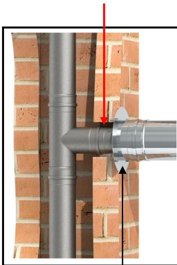
Übergang TEC-LAS-DECO auf Schacht
