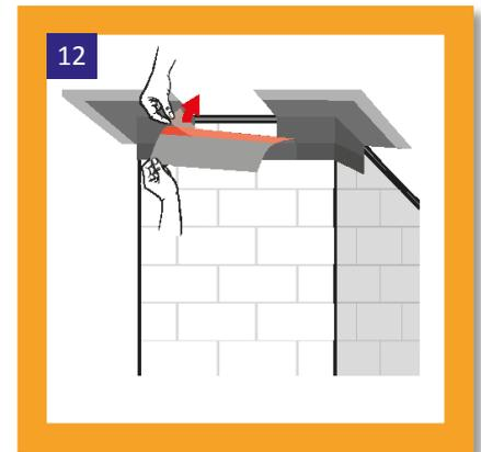
Entfernen Sie die mittig liegende Schutzfolie von dem Anschlussband.
