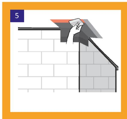
Die Klebefläche mit einem festen Hilfsmittel, z.B. Raker, auf dem Bauteil andrücken.
