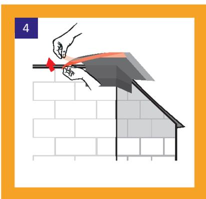
Entfernen Sie den ersten Teil der untenliegenden Schutzfolie des Klebekragens.
