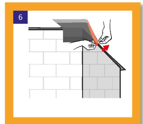
Entfernen Sie den zweiten Teil der untenliegenden Schutzfolie des Klebekragens.
