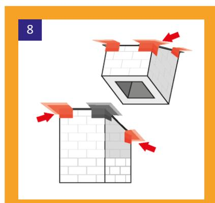
Alle vier Schornsteinabdichtungsmanschetten müssen nach dem gleichen Prinzip angebracht werden. Bitte achten Sie speziell auch auf die angelegten Dachschrägen.
