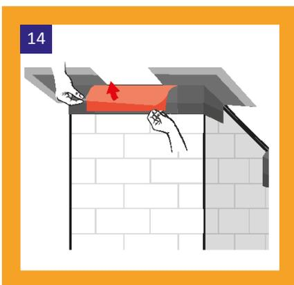
Entfernen Sie den unteren Teil der Schutzfolie des Anschlussbandes.
