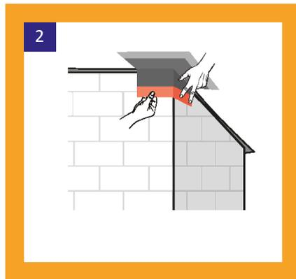
Drücken Sie den Klebekragen flächig an das Bauteil.
