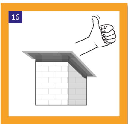
Das Anschlussband muss an allen vier Seiten nach dem gleichen Prinzip verbaut werden. Bitte beachten Sie speziell bei Dachschrägen auf die erforderliche Überlappung von mindestens 3cm.
