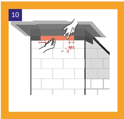
Der Klebekragen wird mindestens 3cm überlappend an der Schornsteinabdeckungsmanschette und an dem Bauteil befestigt.
