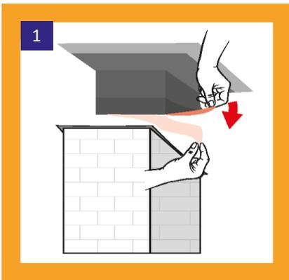
Entfernen Sie die Schutzfolie des obenliegenden Klebekragens.
