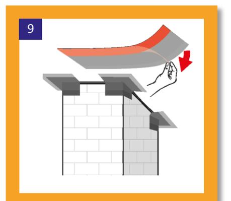
Entfernen Sie die kurzzeitige Schutzfolie des Anschlussbandes.
